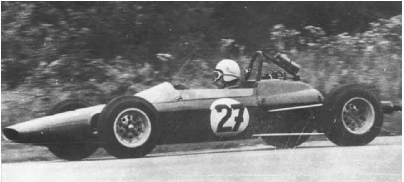
«Классический» образец «Эстонии-9», подготовленной по новым техническим требованиям (автомобиль Петра Евстафьева из РСТК ДОСААФ Латвийской ССР, 1970 г.): высокая и относительно узкая дуга безопасности, установленная взамен старей, и укрепленный на видном месте огнетушитель
