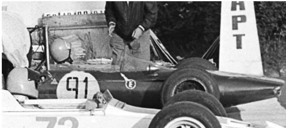
На этом снимке заметны боковые вырезы отверстия воздухозаборника, делавшие автомобиль Панасенко при взгляде сбоку похожим на американский «Игл-Т1G» Дэна Герни
