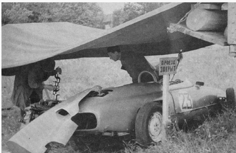
*НАМИ-074Ю, укрытый от дождя брезентом; механики осматривают снятый с двигателя коленчатый вал, пытаются понять, возможно ли произвести ремонт на месте. Сзади к НАМИ-074Ю прислонен капот двигателя от НАМИ-041М*
